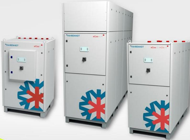
Eine **Adsorptionskältemaschine** (AdKM) kommt im Gegensatz zu einer Absorptionskältemaschine mit einer geringeren Antriebstemperatur aus und nutzen ein festes Sorptionsmittel wie z. B. Aktivkohle, Zeolith oder Silikagel. Zusätzlich erfolgt der Prozess diskontinuierlich und setzt sich aus zwei Phasen zusammen: dem Adsorptions- und Desorptionsprozess. Es reicht eine Antriebstemperatur von 55 - 100 °C. Damit können auch flüssigkeitsgekühlte Server als Wärmequelle verwendet werden.
