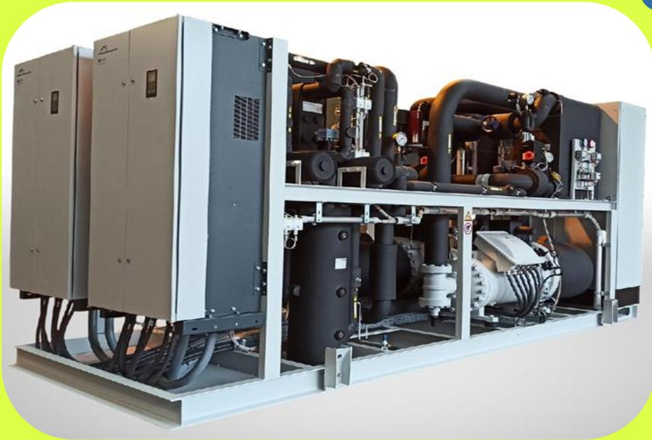
**Hochtemperaturwärmepumpen** sind eine Technologie zur Aufwertung von Wärmequellen auf ein besonders hohes Temperaturniveau. Sie können zum einen Wärme auf einem höheren Temperaturniveau ( $> 100\text{ °C}$ ) als herkömmliche Wärmepumpen bereitstellen und zum anderen Wärme aus höheren Temperaturquellen aufnehmen. Als Wärmequelle werden in der Regel Wasser, Sole, Abluft oder Abwasser in einem Temperaturbereich zwischen  $17$  und  $65\text{ °C}$  verwendet.
